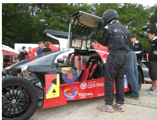
Le prototype Hypnoz, véhicule écologique alliant propulsion thermique et traction électrique
